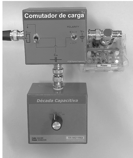
Conmutador de carga, década capacitiva y fuente de tensión de precisión.
